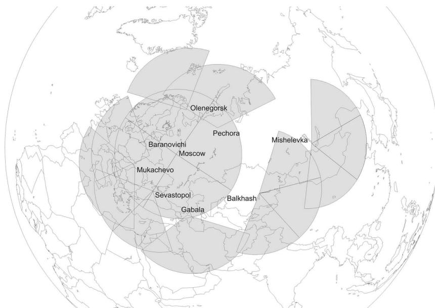
**Рис. А-4.** Радиолокаторы раннего предупреждения и противоракетной обороны России. Размеры полей приема радиолокатора могут не соответствовать дальности обнаружения радиолокатора.
