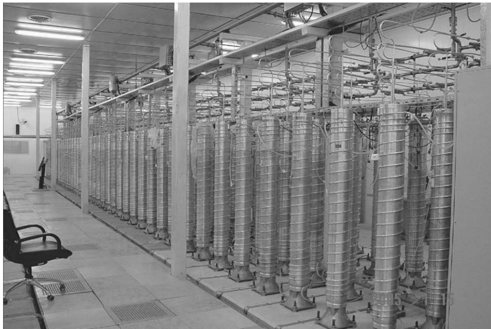
Рис.1: Иранская разделительная установка в Натанзе, где, судя по сообщениям, работают 164 центрифуги.
