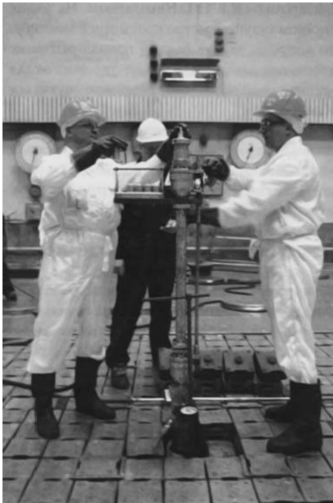
Рис. 2. Загрузка топливных элементов в канал работающего реактора. Заимствовано из книги История сибирских АЭС с продолжением, 2008 год .
