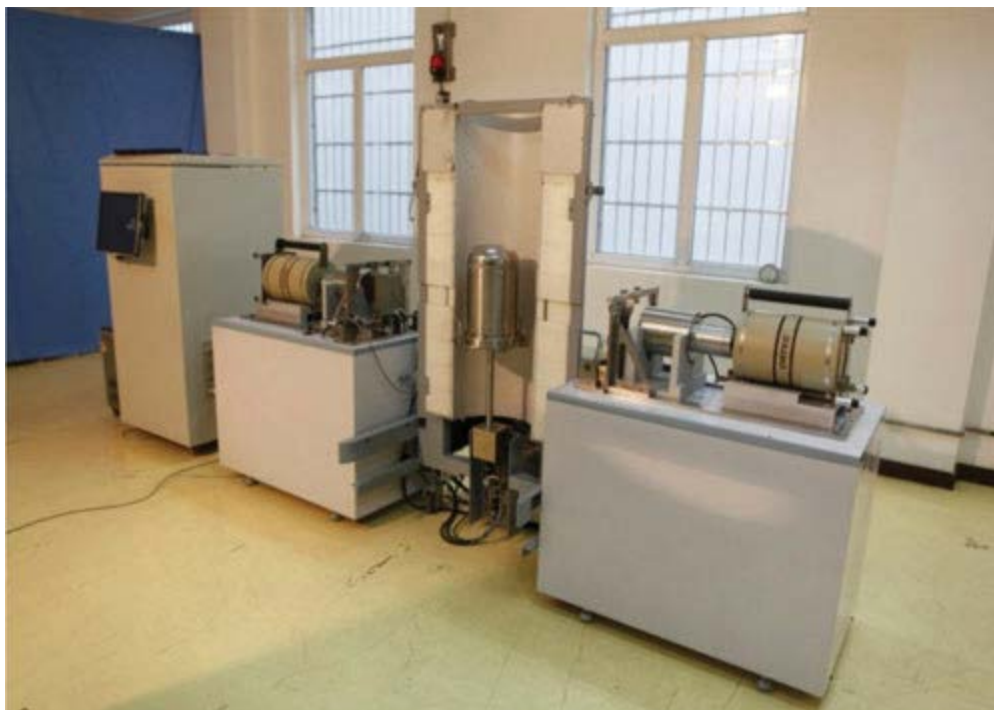
Рисунок 1. Система измерения атрибутов плутониевых сборочных узлов с информационным барьером.
