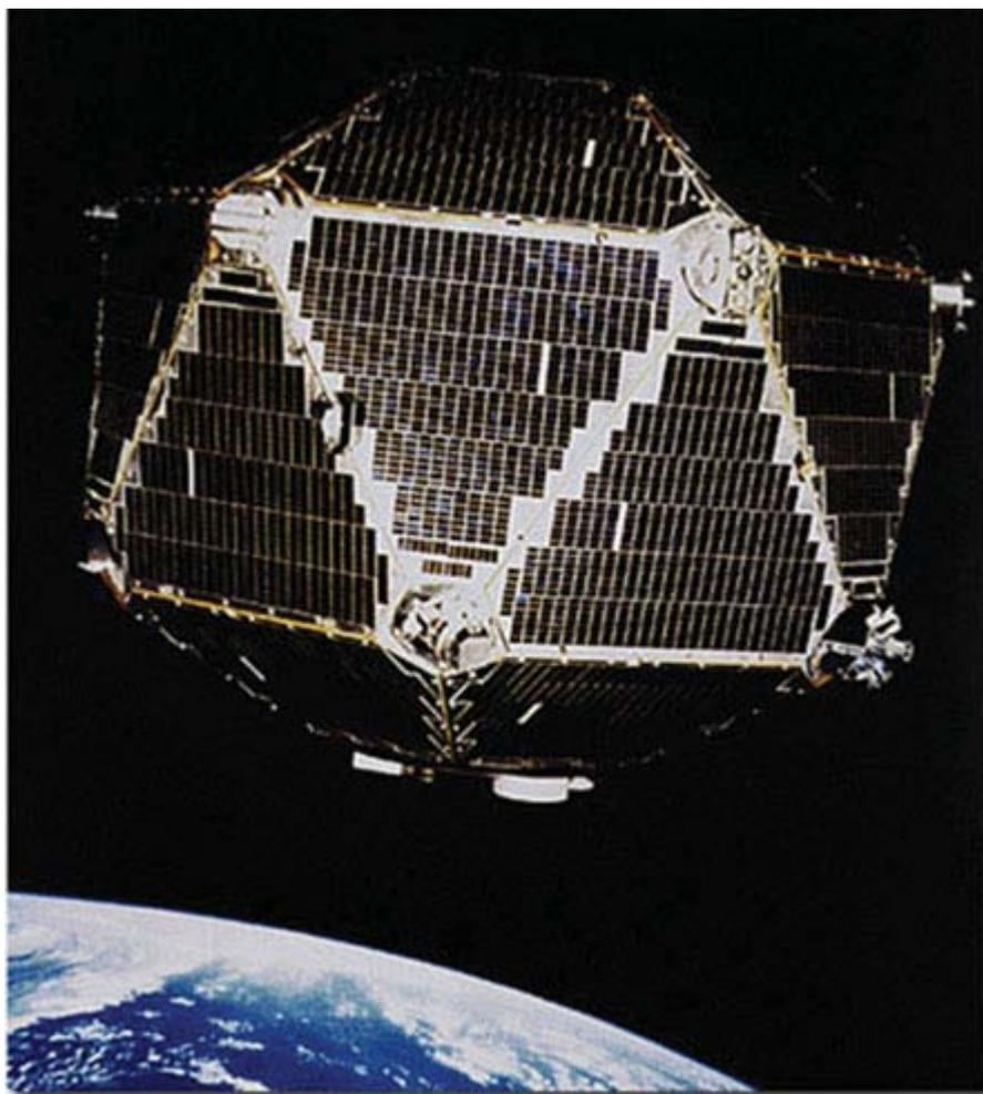
**Рисунок 5.** Внешний вид спутника Вела 6911 на орбите над Землей. Из 26 сторон 24 покрыты солнечными панелями, обеспечивающими электропитание космического аппарата. Белые детали на нижней стороне представляют собой концы светозащитных блендов, направленных на Землю, которая находится также на оси вращения космического аппарата. Другие радиационные датчики на вершинах (пересечениях) нескольких панелей направлены в космос для обнаружения ядерных взрывов за пределами атмосферы.
