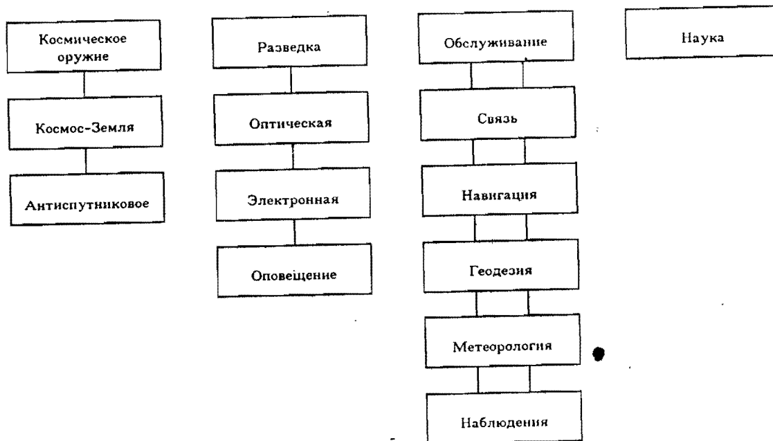
Рисунок 3 Классификация космических систем по выполняемым задачам
