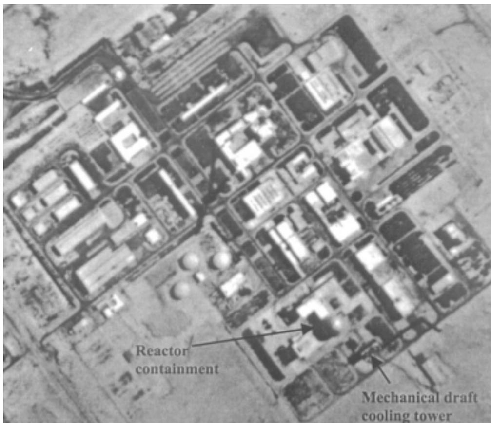
Рис.5: Рассекреченный снимок с американского спутника, работавшего по программе "Корона", где приведено изображение ядерных установок в Димоне (Израиль). Съемка производилась спутником КН-4В 29 сентября 1971 г. с пространственным разрешением 1.8 м. Стрелками указаны реактор и градирня.
