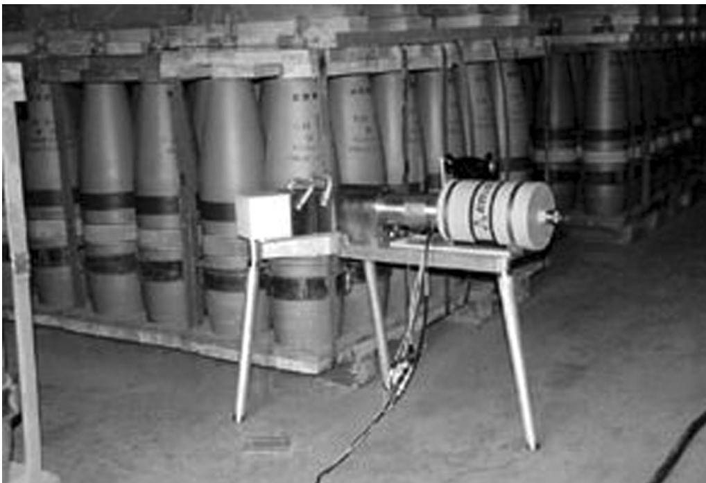
Рис. А-1. Поддоны с 155-мм снарядами, в каждом из которых содержится примерно 3 кг нервно-паралитического агента GB (зарина), на установке по утилизации химических агентов в Туэле, штат Юта. Снаряды изготовлены из высокопрочной стали. До сжигания эти снаряды открываются при помощи резакв с дистанционным управлением, и из них извлекается разрывной заряд. Даже при температурах, превышающих 1000 °C, требуется около часа для того, чтобы полные емкости с заринем испарились и агент был уничтожен. На переднем плане показана установка, являющаяся частью эксперимента для разработки метода неdestructивного отождествления агента при помощи нейтронной спектроскопии. Источник: Helmuth, L, Seeing Through Steel: INEEL-Developed Technology Identifies Chemical Weapons . Доступно в сети Интернет по адресу http://www.eurekalert.org/pub.releases/1998-10/INEE-STSI-141098.php (получено 1 апреля 2004 г.).
