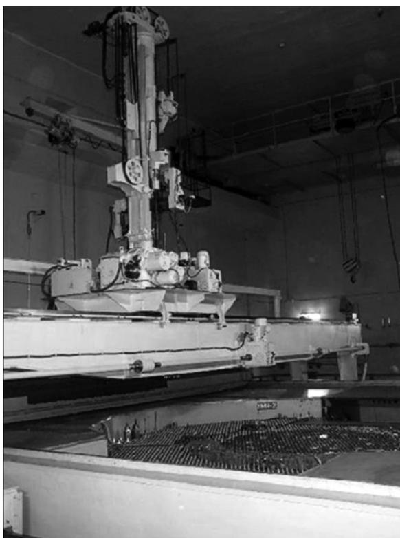
Рисунок 1. Критическая установка БФС-2. Машина над критической сборкой используется для размещения и удаления топливных сборок и трубок.
