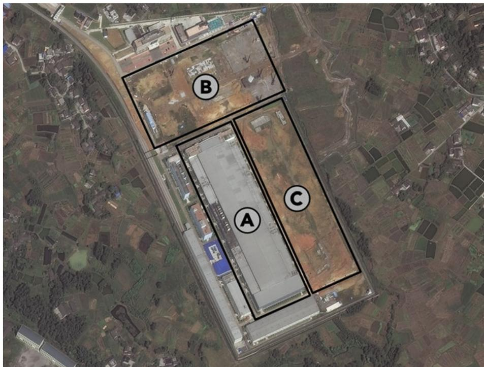
Рисунок 4. Предприятия Эмэйшан 1 и Эмэйшан 2 в Шунфу в окрестностях города Эмэйшан. А: Эмэйшан 1 (действующее); В: Эмэйшан 2 (строящееся); С: место, подготовленное для дополнительного проекта с центрифугами. Снимок со спутника 5 октября 2014 года (координаты: 29°40'38,33" с.ш. / 103°32'04,65" в.д.). ©DigitalGlobe. Воспроизведено с разрешения ©DigitalGlobe. Разрешение для повторного использования должно быть получено от правообладателя.
