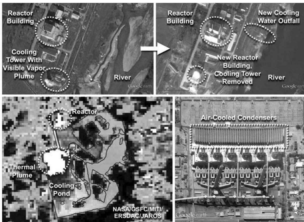
Рисунок 1. Примеры систем охлаждения и конечных стоков тепла: клубы пара из градирни (вверху слева) 5 ; та же самая площадка после сноса градирни, строительства нового реактора, и возможного сброса охлаждающей воды (вверху справа) 6 ; изображение в инфракрасном диапазоне реактора атомной электростанции и его бассейна для охлаждения воды (внизу слева) 7 ; электростанция Матимба, угольная электростанция с мощностью 4 ГВт(эл.) – самая крупная в мире электростанция с прямым воздушным охлаждением (внизу справа). Пояснения авторов на рисунках (из левого верхнего угла против часовой стрелки): 1 – здание реактора, 2 – градирня с видимым клубом пара, 3 – река (вверху слева); 1 – здание реактора, 2 – новое здание реактора, градирня снесена, 3 – река, 4 – новый сброс охлаждающей воды (вверху справа); 1 – реактор, 2 – тепловой султан, 3 – бассейн охлаждения (внизу слева); 1 – конденсаторы с воздушным охлаждением (внизу справа).
